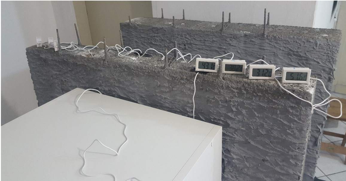
Figura 10 - Parede sendo acoplada com termômetros
